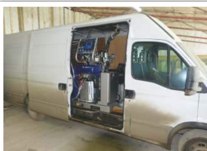
Автономная установка для напыления ППУ - GRACO Reactor E-30i
